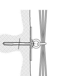
PANNELLI DI RETE scala 1:10 Anello di giunzione dei pannelli di rete Fune di armatura verticale Filo perimetrale del pannello di rete Anello di giunzione dei pannelli di rete
