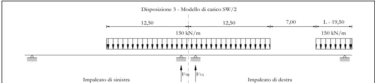
Figura 26 – Disposizione di carico 3
