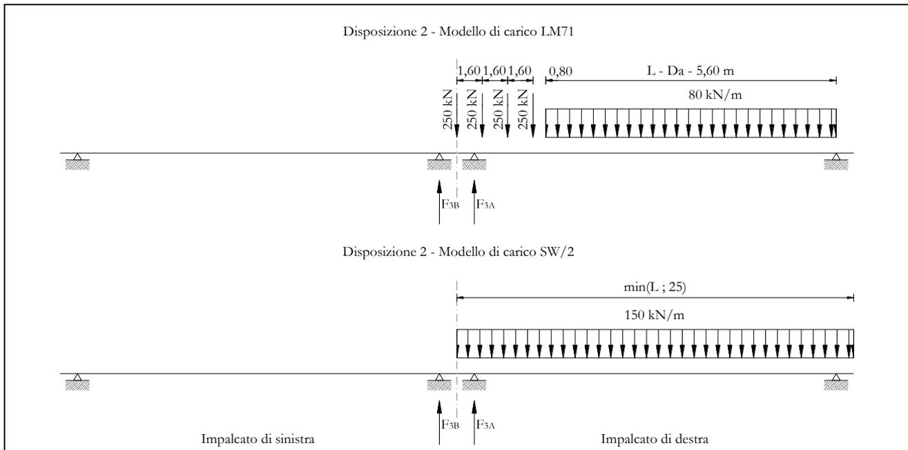
Figura 25 – Disposizione di carico 2
