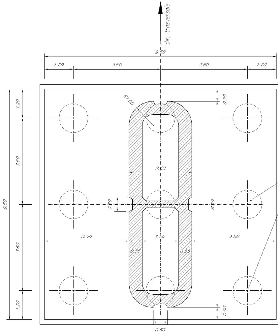
Figura 3 – Plinto di fondazione e pali, vista in pianta - Sezione del fusto pila [m]
