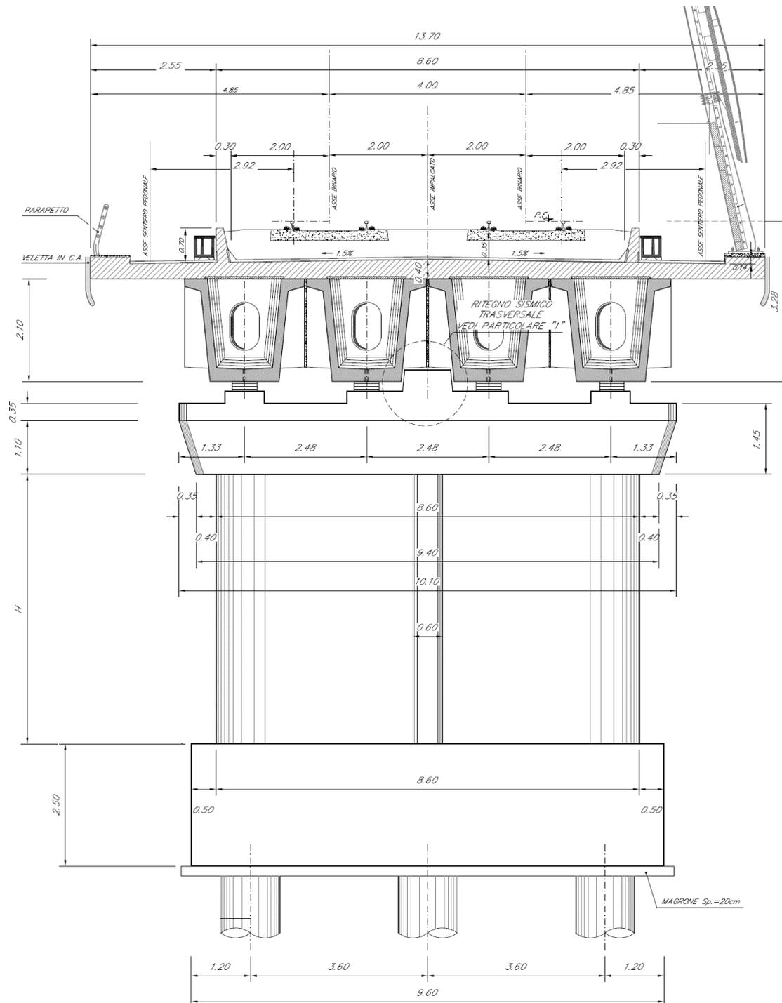
Figura 1 – Pila, prospetto frontale – Impalcato in C.A.P. [m]
