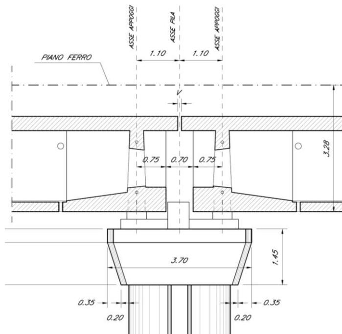
Figura 4 – Pila, prospetto longitudinale – Due impalcati CAP
