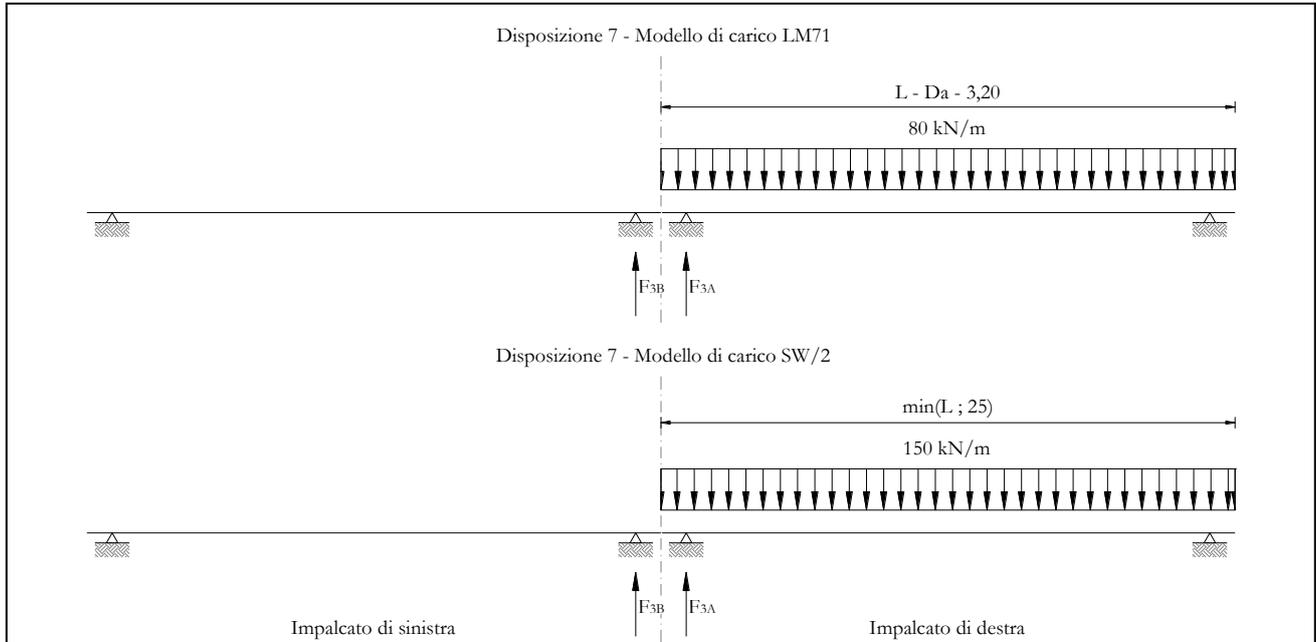
Figura 23 – Disposizione di carico 7
