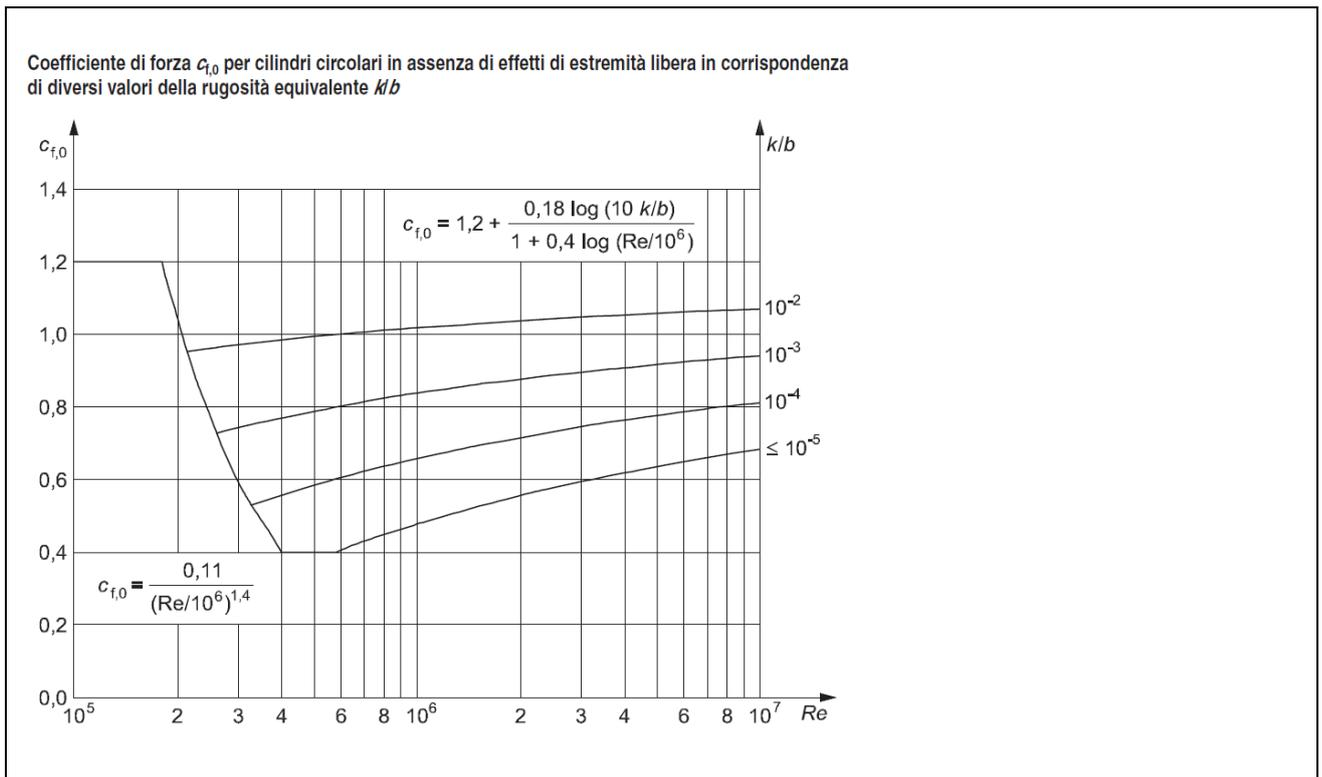
Figura 40 – Correlazione tra numero di Reynolds, la rugosità equivalente e coefficiente di forma  $c_{f,0}$  (figura 7.28 EC1-4)
