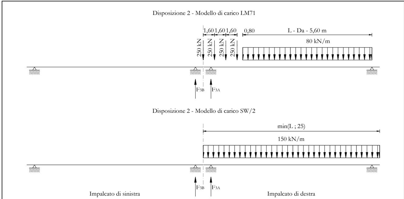
Figura 32 – Disposizione di carico 2
