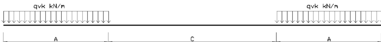
Figura 4 – Treno di carico SW
