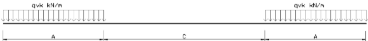
Figura 5 – Treno di carico SW
