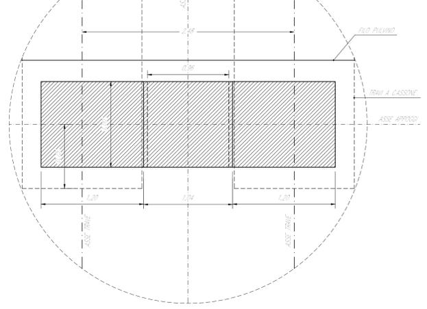
DETTAGLIO BATTUTA RITEGNI SISMICI Scale 1:5
