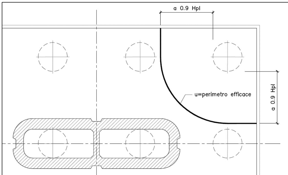
Figura 3 – Perimetro efficace per la verifica a taglio-punzonamento
