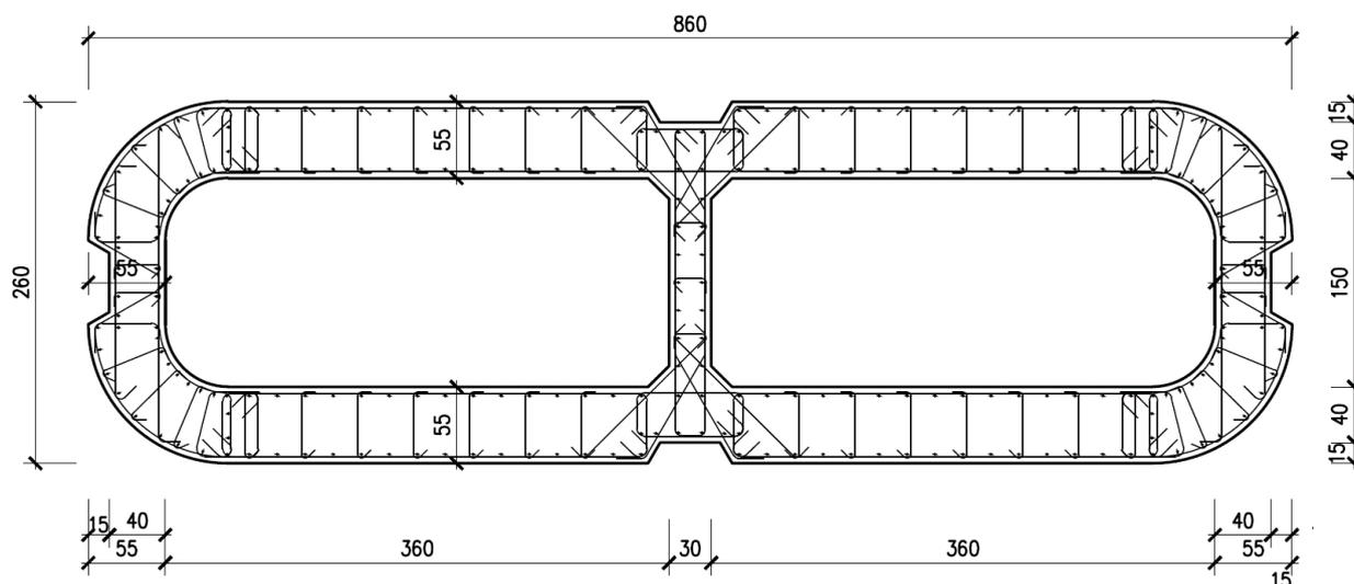
Figura 1 – Geometria della sezione trasversale della pila [cm]
