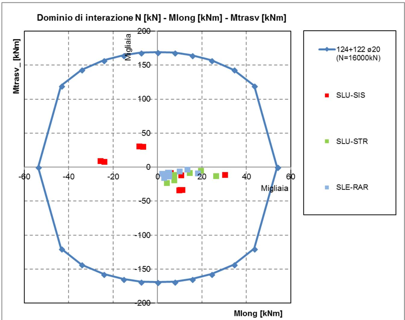
Si riportano a seguire le verifiche in forma esplicita nelle due combinazioni di carico più severe, di cui la prima ricadente in condizione statica SLU e la seconda ricadente in condizione sismica SLV.
