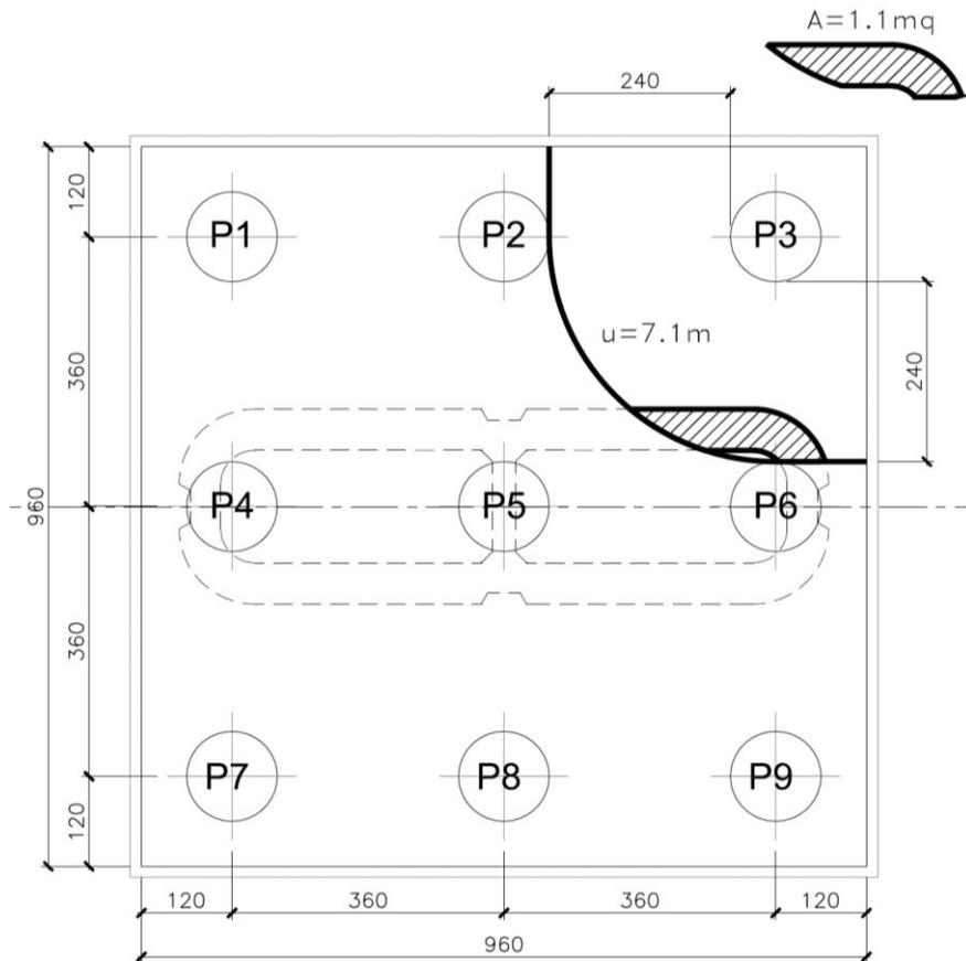
Figura 47 – Perimetro efficace per la verifica a taglio-punzonamento
