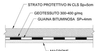
DETTAGLIO PACCHETTO IMPERMEABILIZZAZIONE SOLETTA DI COPERTURA
