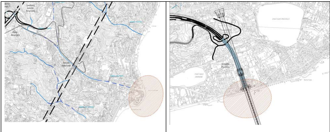
Figura 6.3. Area di possibile evoluzione del cuneo salino – zona Annunziata, zona fondazioni delle torri.
