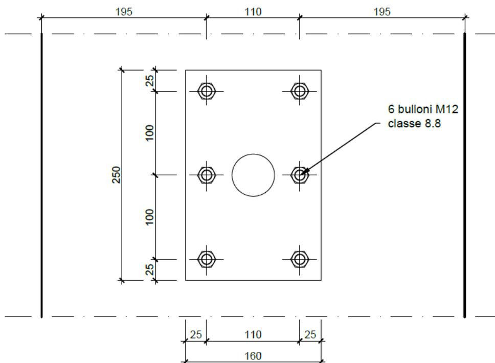
Figura 6-1: Ancoraggio linea vita dispositivo tipo C
