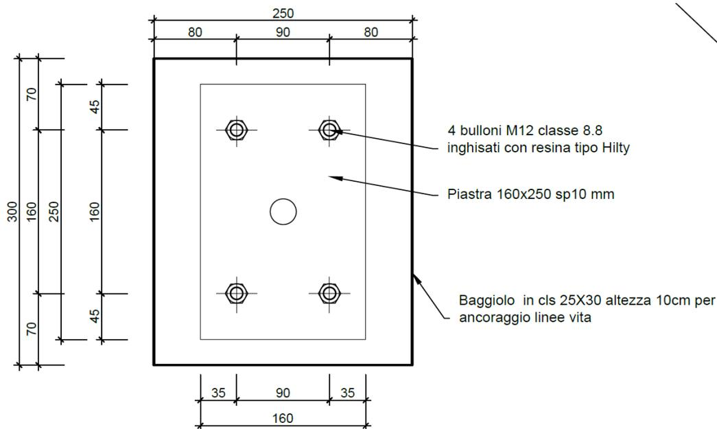
Figura 6-2: Ancoraggio linea vita dispositivo tipo A
