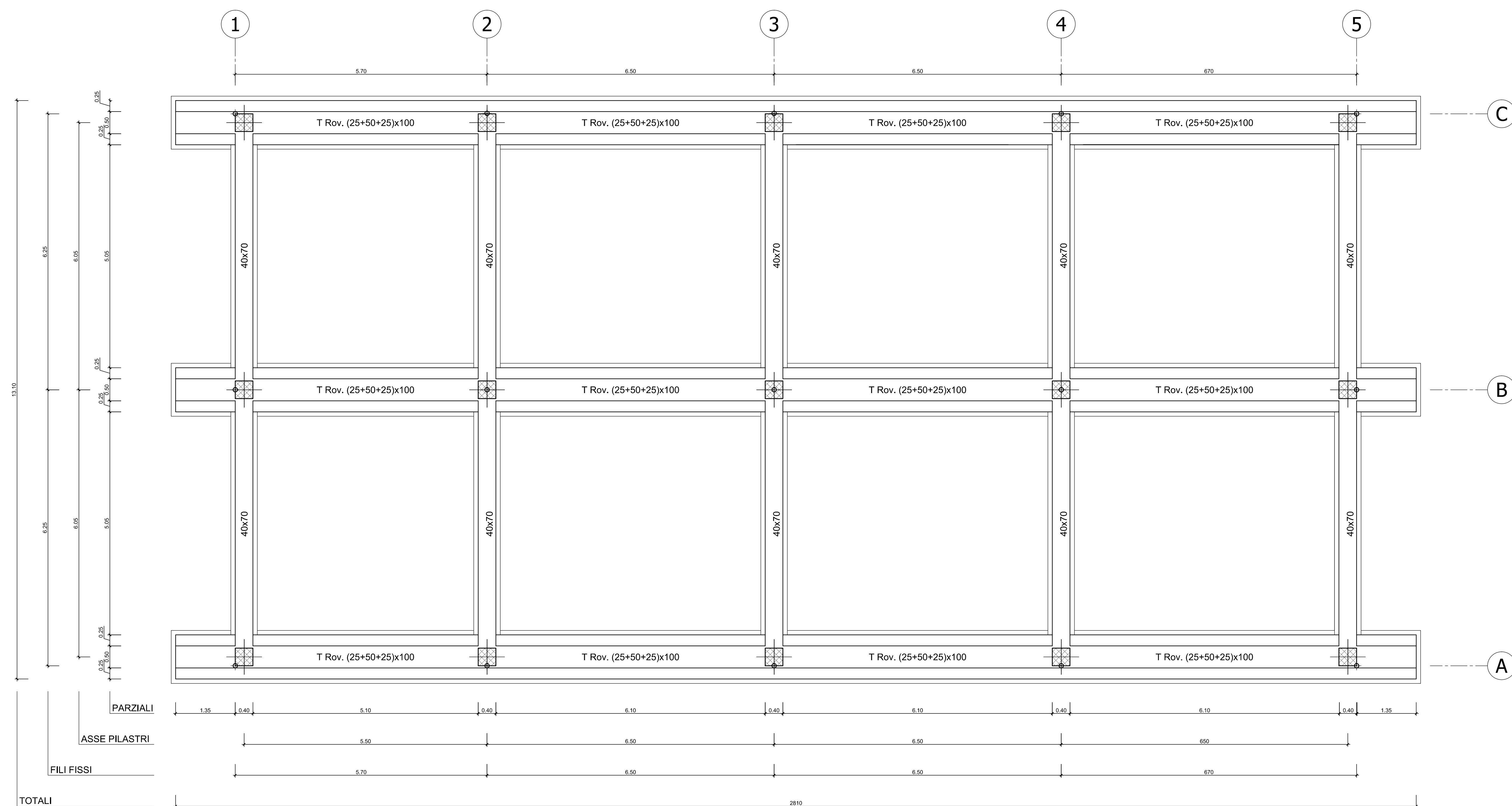
PIANTA FONDAZIONE - QUOTA -0.80 SCALA 1:50
