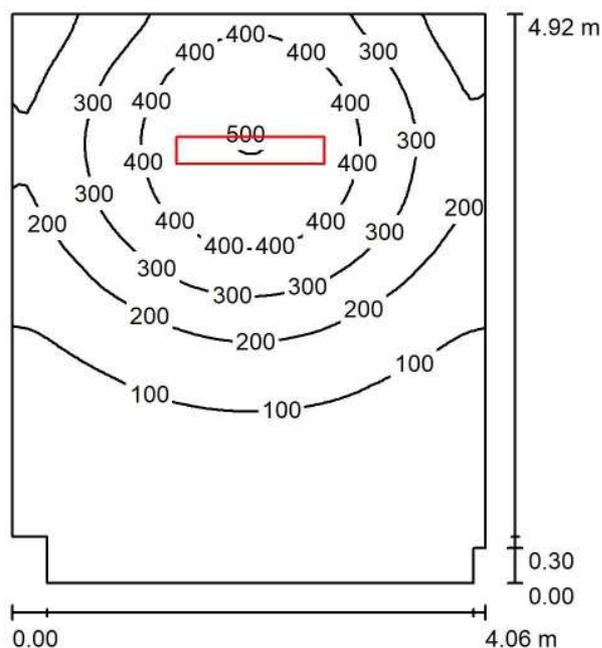
Altezza locale: 3.200 m, Altezza di montaggio: 3.200 m, Fattore di manutenzione: 0.80
