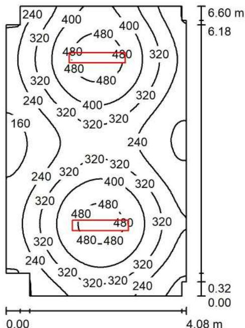
Altezza locale: 3.200 m, Altezza di montaggio: 3.200 m, Fattore di manutenzione: 0.80
