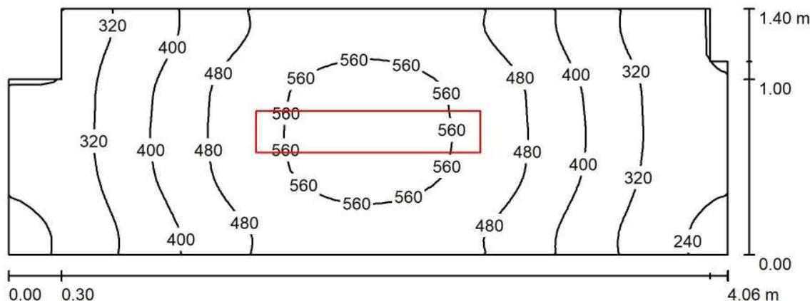
Altezza locale: 3.200 m, Altezza di montaggio: 3.200 m, Fattore di manutenzione: 0.80
