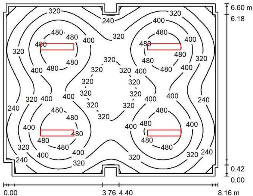
Altezza locale: 3.200 m, Altezza di montaggio: 3.200 m, Fattore di manutenzione: 0.80
