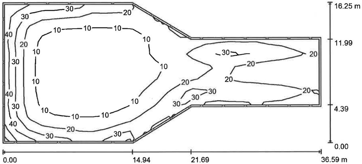
Altezza locale: 8.620 m, Altezza di montaggio: 2.700 m, Fattore di manutenzione: 1.00
