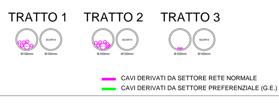
PARTICOLARI RIEMPIMENTO TUBAZIONI PRINCIPALI PER TRATTA IN POLIFERA
