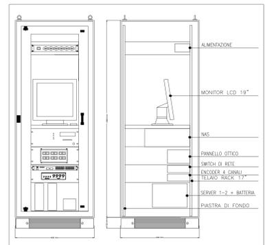
**PARTICOLARE TIPOLOGICO COLLEGAMENTO APPARATI PRINCIPALI**
