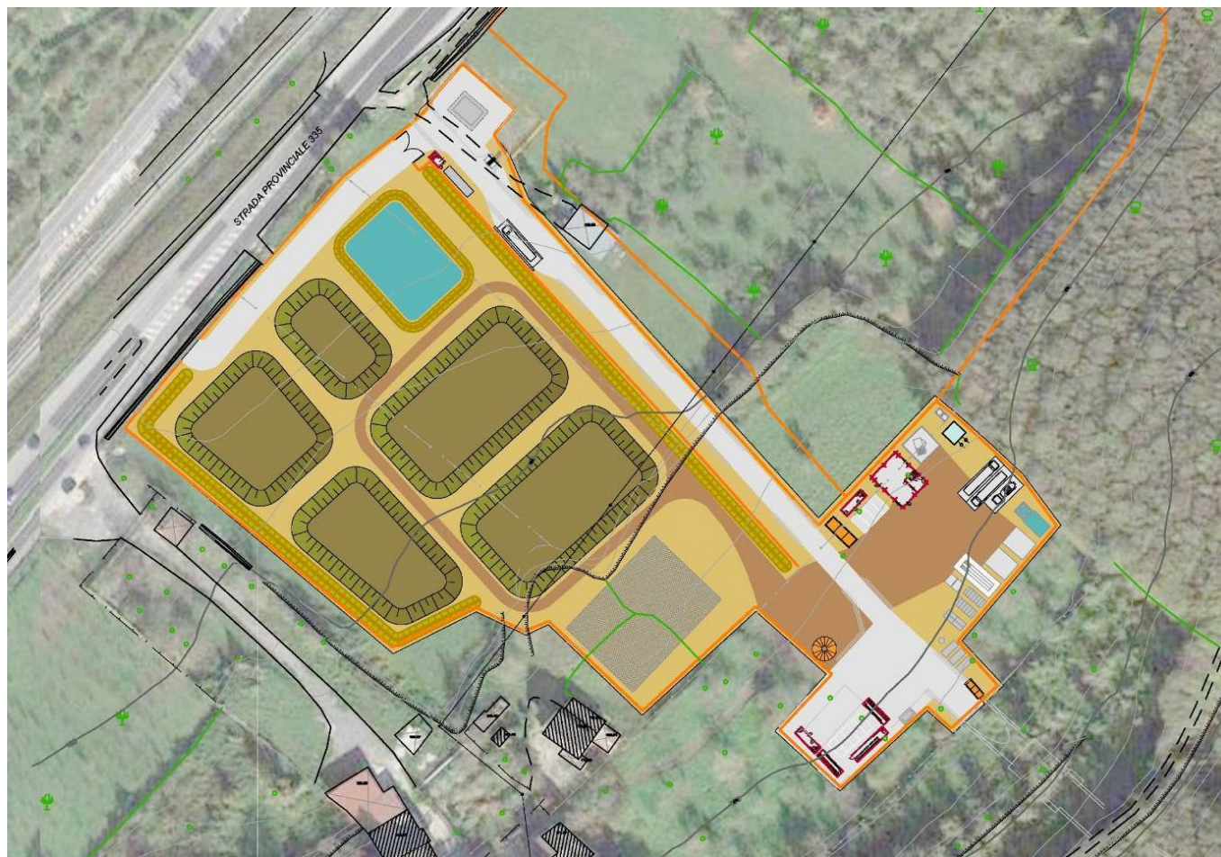
Figura 30 – Layout esemplificativo area di cantiere con localizzazione delle aree destinate al deposito terre
