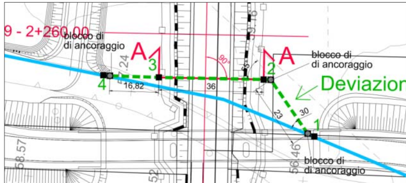
Figura 4.5 – Deviazione AQ01bisin corrispondenza dell’attraversamento
