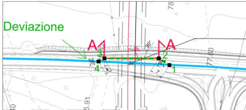
Figura 3.2 – Deviazione FO01 in corrispondenza dell’attraversamento
