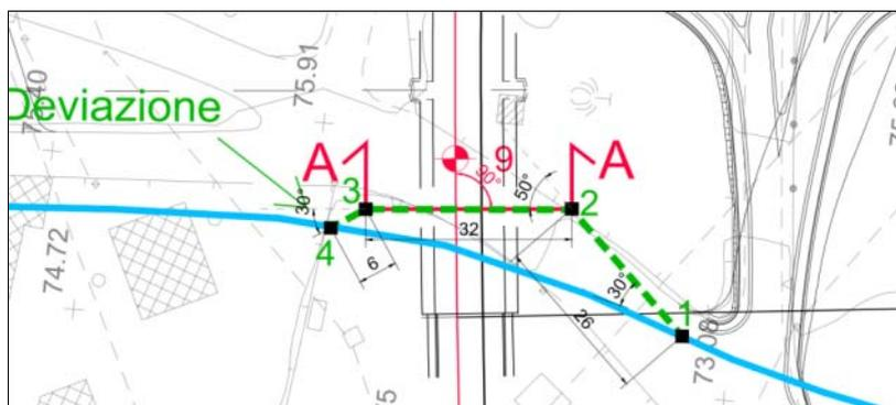
Figura 1 – Deviazione AQ02 in corrispondenza dell'attraversamento
