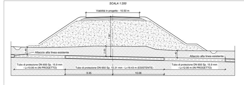
SEZIONE TIPO ATTRAVERSAMENTO LINEA FERROVIARIA
