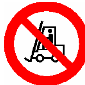
DIVIETO DI TRANSITO AI CARRELLI
