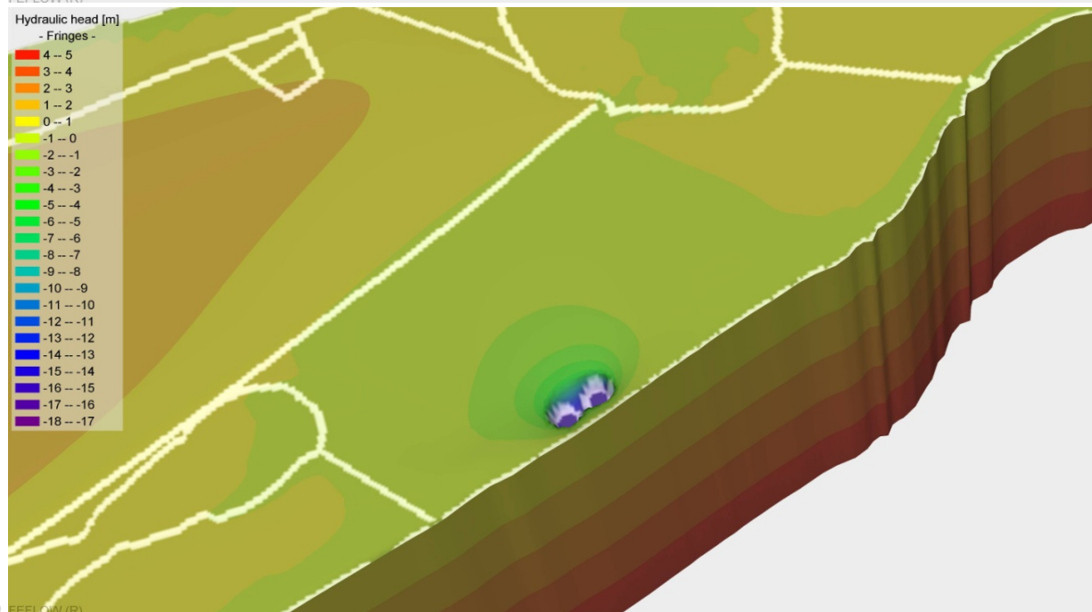
Figura 23. Vista tridimensionale della distribuzione dei carichi idraulici calcolata nel dominio di flusso ampio nella simulazione conservativa di massima estensione (esagerazione verticale 5:1).
