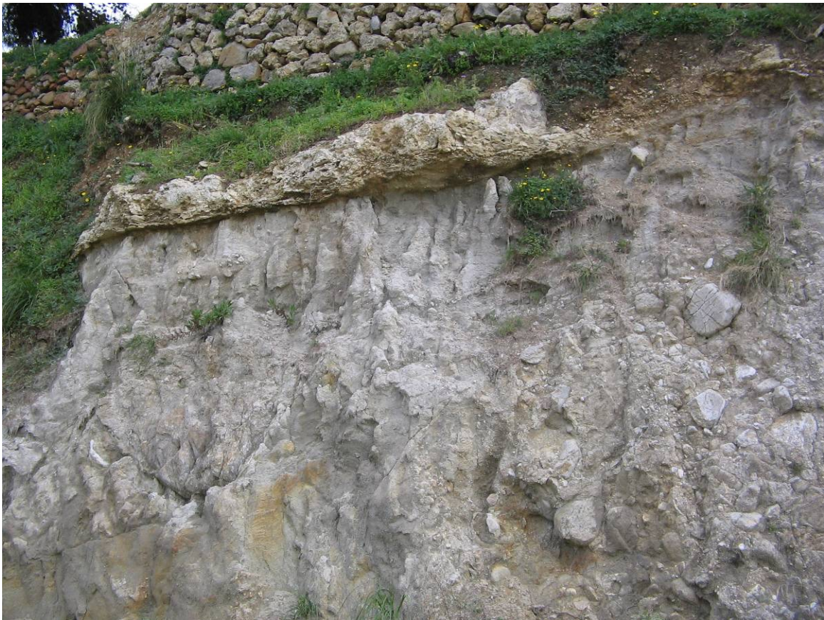
Figura 2.5.1.32 - Affioramento del contatto trasgressivo tra la facies marnosa e quella calcarenitica dei Trubi a valle della stazione di servizio autostradale.
