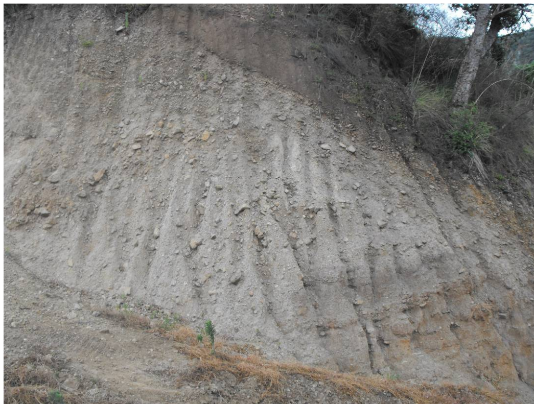
Figura 2.5.1.46 - Depositi eluvio-colluviali soprastanti depositi di versante clinostratificati, eterometrici ed a clasti visibilmente spigolosi, osservabili presso il Vallone Piria.
