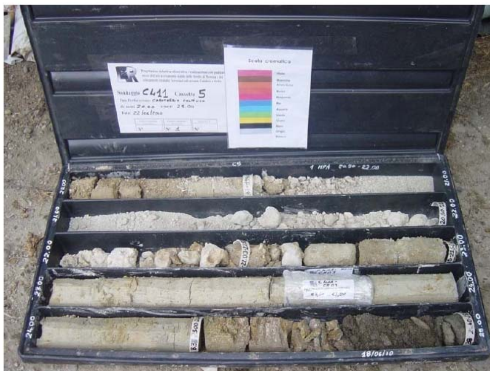
Fig. 3.17 – Contatto tra Trubi e Conglomerato di Pezzo osservato nel sondaggio C411 a circa 25m dal p.c.. Si notano sovrapposte la facies calcarenitica e quella marnosa dei Trubi nell'intervallo di profondità 22-25 m dal p.c..
