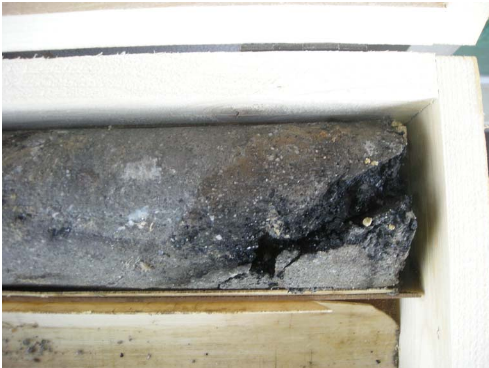
Fig.3.13 – Dettaglio di una carota di Conglomerato di Pezzo ottenuta dal sondaggio C406 (profondità di circa 35 m dal p.c.) contenente, tra due clasti, materia organica carboniosa.
