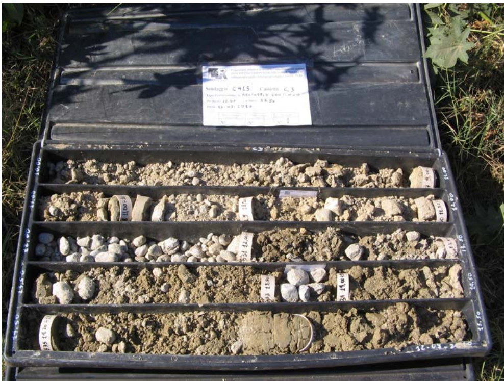
Fig. 3.28 – Carote di Sabbie e Ghiaie di Messina ottenute dal sondaggio C415, è ben evidente la natura sciolta dei depositi e l'eterometria dei clasti.
