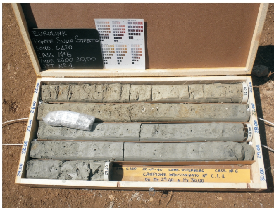
Fig. 3. 16 – Marne della Formazione dei Trubi, carotate dal sondaggio C420
