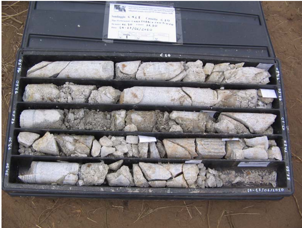
Fig. 3.4 – Carote di rocce granitoidi del substrato ercinico ottenute dal sondaggio C428
