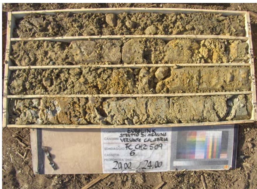
Fig. 3.36 – Depositi sabbioso-ghiaiosi di piana costiera in contatto sul Conglomerato di Pezzo, carotati nel sondaggio FC_CH2_509.
