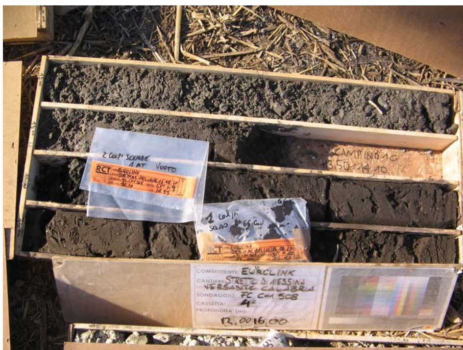
Fig. 3.36 – Depositi sabbioso-ghiaiosi di piana costiera in contatto sul Conglomerato di Pezzo, carotati nel sondaggio FC_CH2_509.
