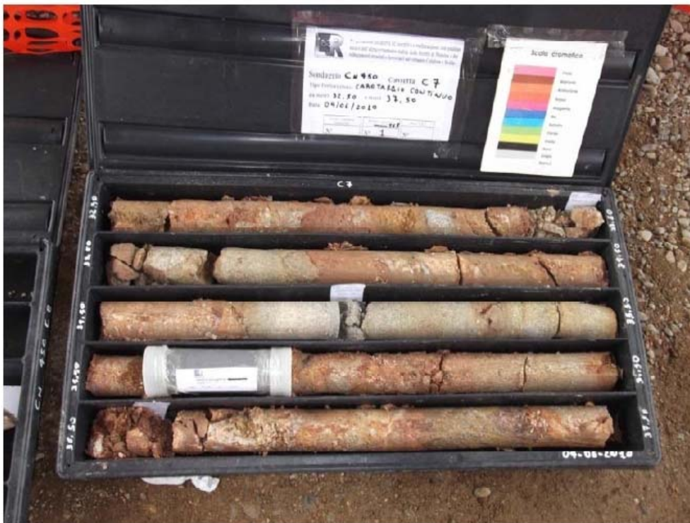
Fig.3.10 – Carote di Conglomerato di Pezzo contenente clasti rubefatti, ottenute dal sondaggio Cn450.
