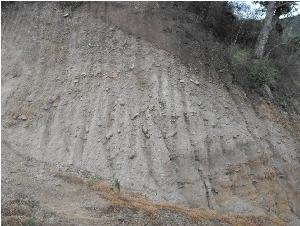
Fig. 3.34 - Depositi eluvio-colluviali soprastanti depositi di versante clinostatificati, eterometrici ed a clasti visibilmente spigolosi, osservabili presso il Vallone Piria
