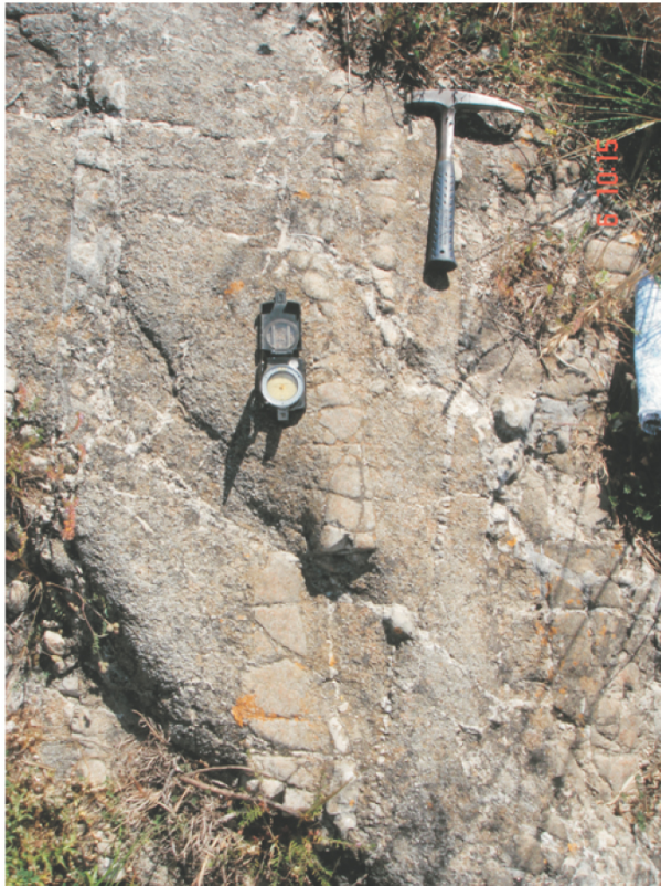
Fig 4.2 Foto e schema interpretativo dell'intensa fatturazione registrata all'interno del substrato granitico in corrispondenza del Sistema di Matiniti. In grigio sono evidenziati gli elementi guida identificati nell'ammasso roccioso completamente disarticolato da fratture estensionali e faglie mesoscopiche con rigetti centimetrici. Gran parte degli elementi presentano caratteri cinematici di tipo trascorrente sia sinistro sia destro a testimoniare la polifasicità dei processi di deformazione.
