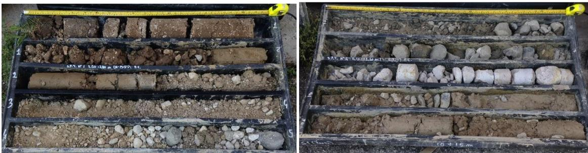
Sondaggio SS6 da m 0 a m 5 e da m 10 a m 15
