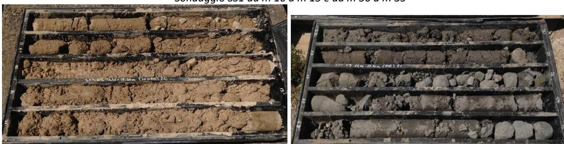
Sondaggio SS2 da m 15 a m 20 e da m 25 a m 30
