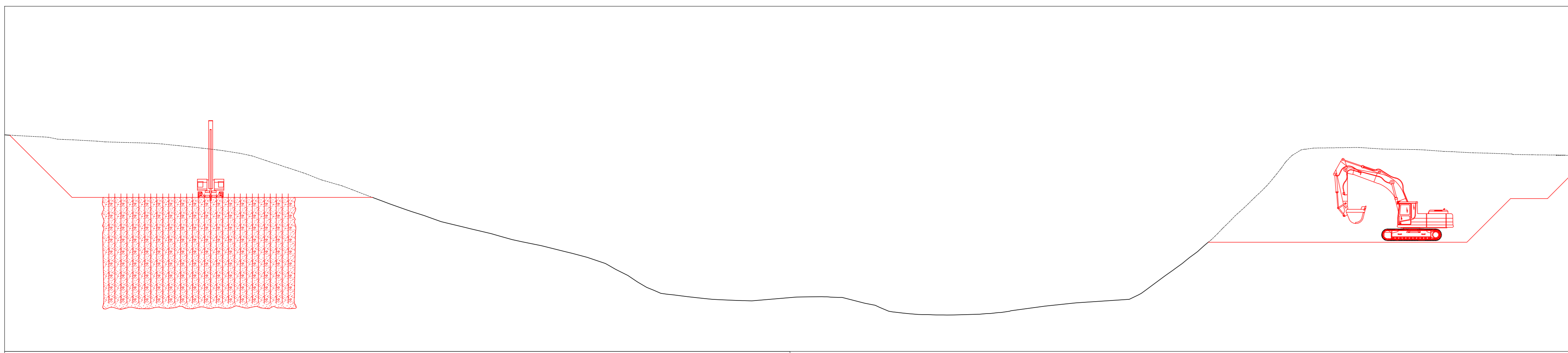
FASE 1) ESECUZIONE DEGLI SCAVI DI FONDAZIONE E CONSOLIDAMENTO DEL TERRENO CON JET-GROUTING
