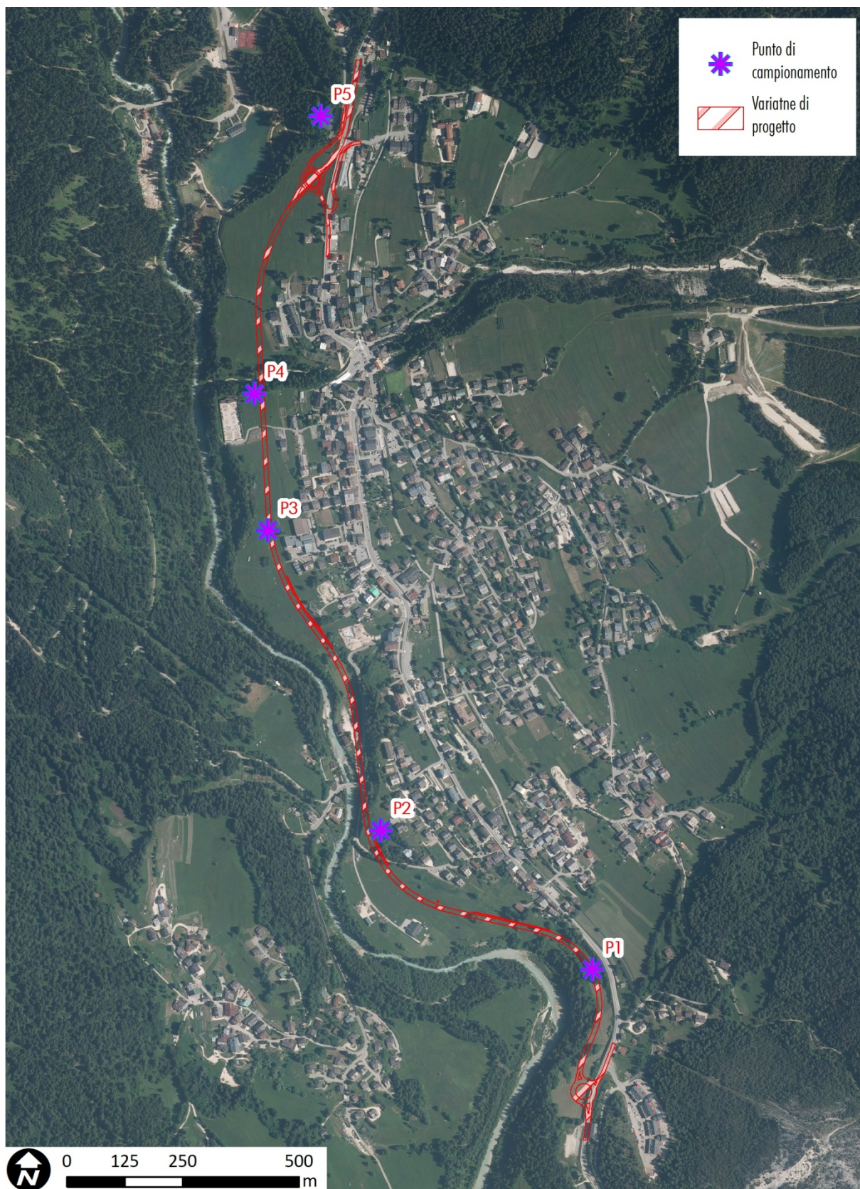
Figura 6: Punti di campionamento delle terre e rocce da scavo.
