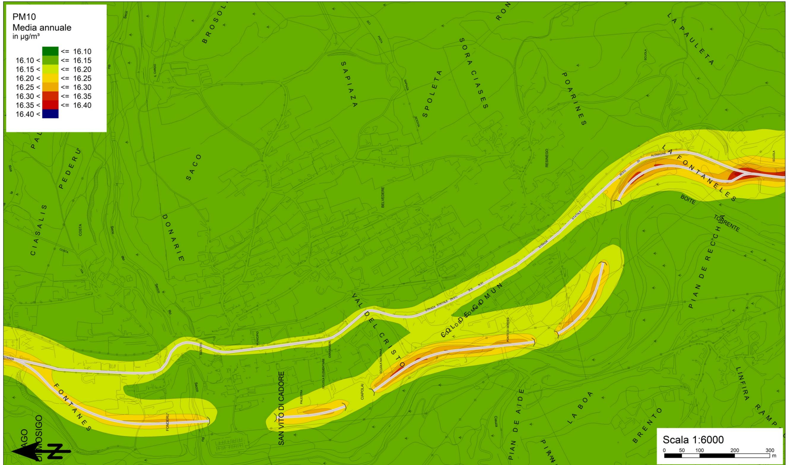
Figura 13: Concentrazione media annuo di PM10 dovuta al traffico sulla S.S. 51 - Alemagna allo stato di progetto considerando un valore di background di  $16,1 \mu\text{g}/\text{m}^3$ .
