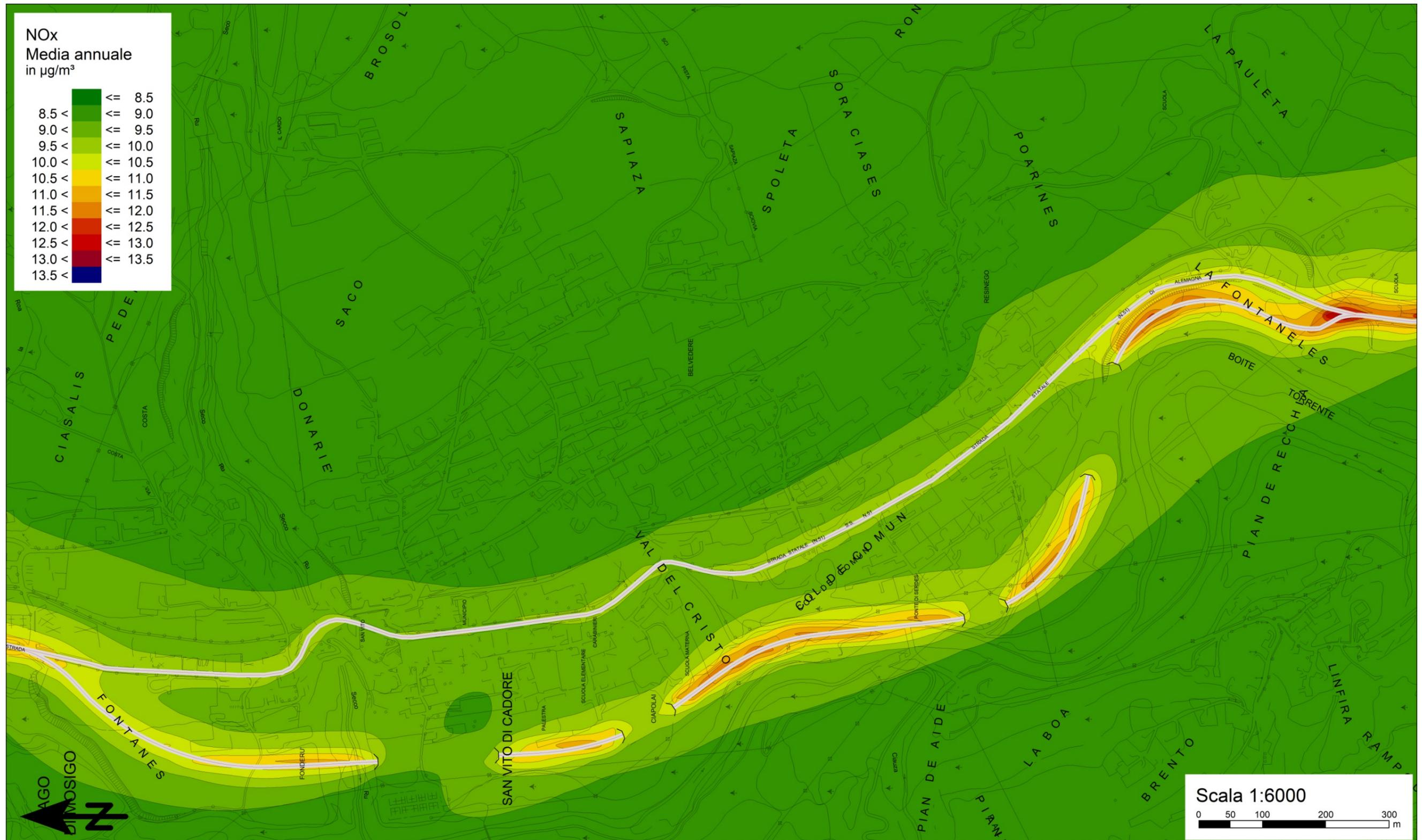
Figura 11: Concentrazione media annuo di NOx dovuta al traffico sulla S.S. 51 - Alemagna allo stato di progetto considerando un valore di background di  $8,6 \mu\text{g}/\text{m}^3$ .
