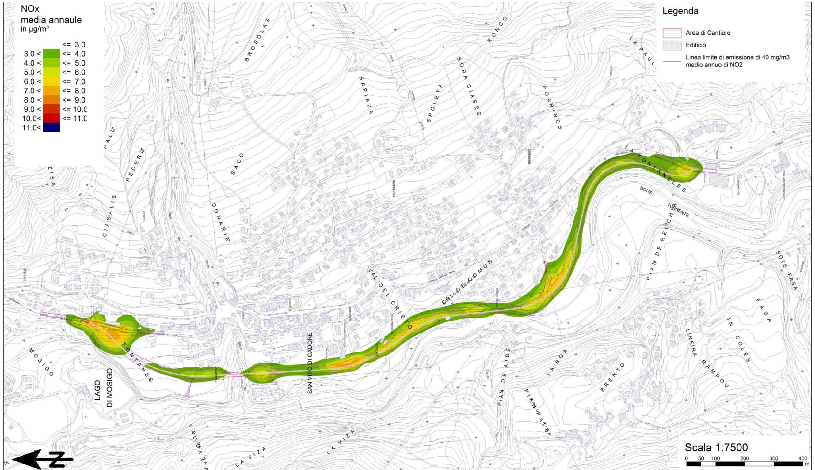
Figura 9: Incremento della concentrazione media annuo di NOx dovuta allo svolgimento delle attività di cantiere.
