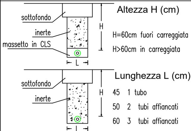
sezione tipo per canalizzazione ortogonale alla strada
