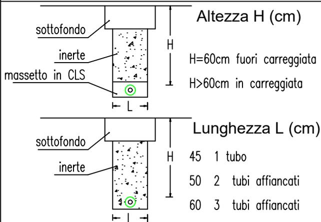
sezione tipo per canalizzazione ortogonale alla strada
