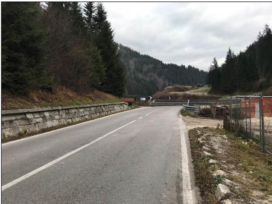
**Note:** il muro esistente parallelo alla S.S. N. 52 sulla corsia Sud (lato destra idraulica) verrà arretrato, nella parte terminale in prossimità del ponte, per facilitare la realizzazione della curva di inserimento; il nuovo muro sarà rivestito in pietra locale. E' inoltre possibile notare le caratteristiche costitutive dei rivestimenti in pietra del muro posto a lato della strada.
