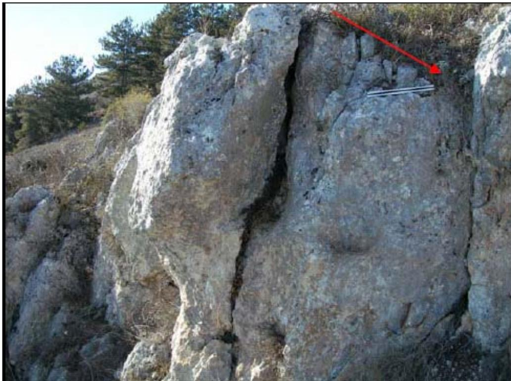
Foto 2/A: Stratificazione in prossimità dell'imbocco meridionale del tunnel
