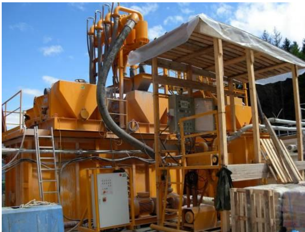
Fig. 2.17 - Sistema di disidratazione
