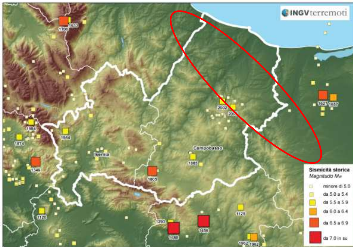
Fig. 5.1 - Distribuzione della sismicità storica nel territorio interessato dal passaggio della condotta negli ultimi mille anni.
