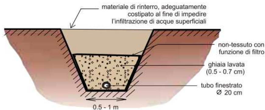
Fig. 5.11 - Trincea drenante sotto condotta.
