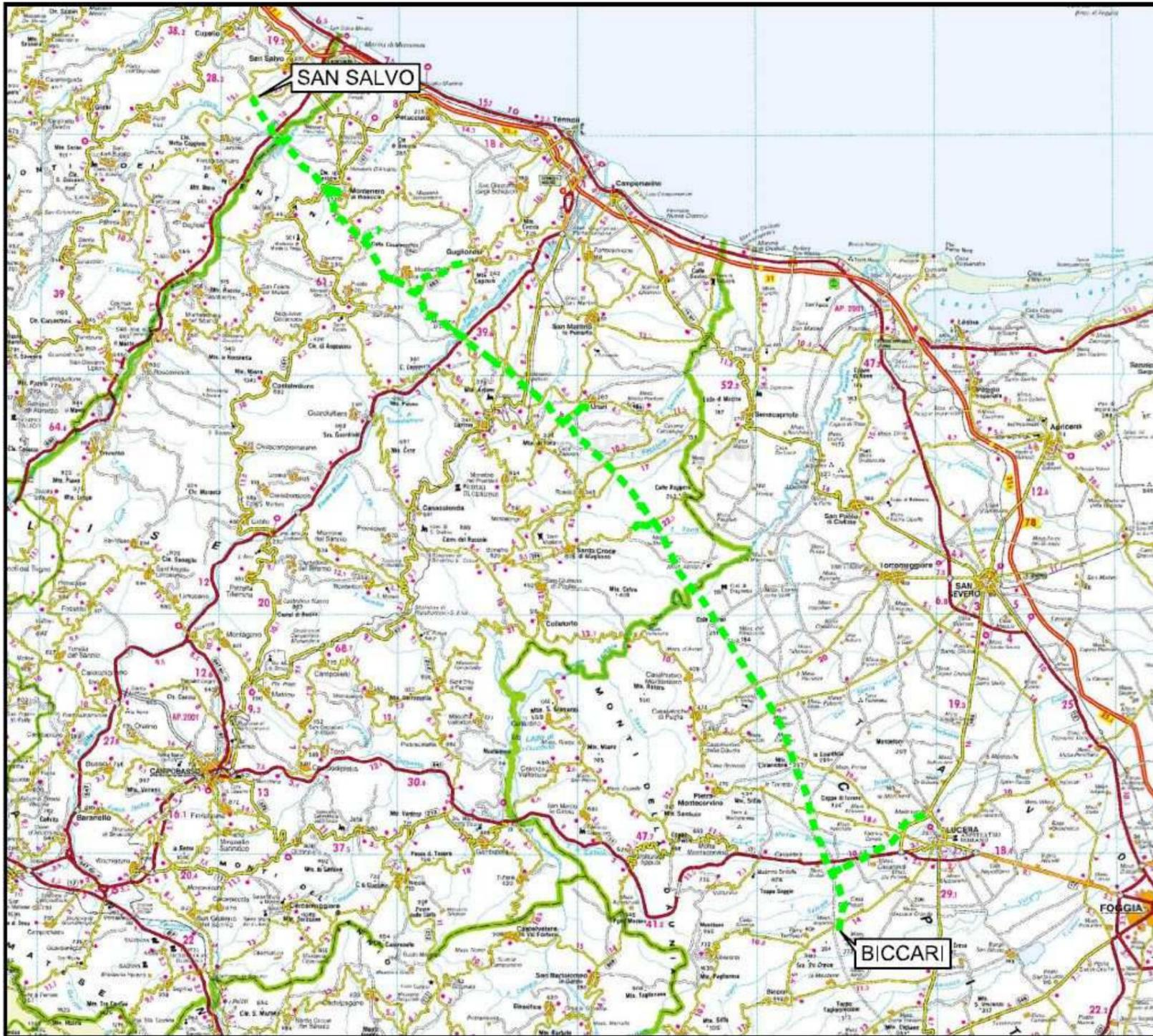
**Fig. 1.1 - Inquadramento generale delle opere in rimozione identificate con linea verde: Metanodotto San Salvo – Biccari DN 500 (20"), MOP 64 bar e opere connesse.**
