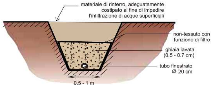
Fig. 8.11 - Trincea drenante sotto condotta.
