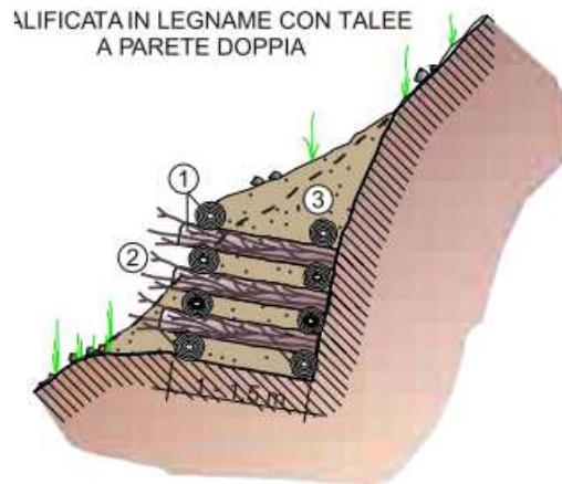
Fig. 8.4 - Muro cellulare in legname a parete doppia
