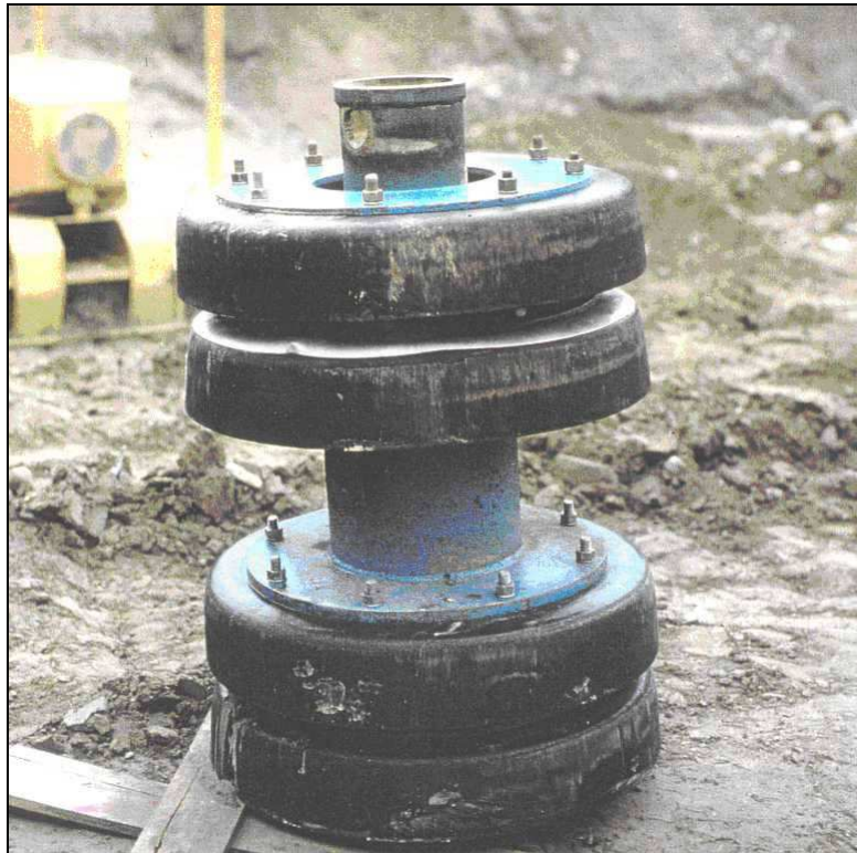
Fig. 6.1 - Pig convenzionale impiegato nelle operazioni di collaudo idraulico e di pulizia della condotta.
