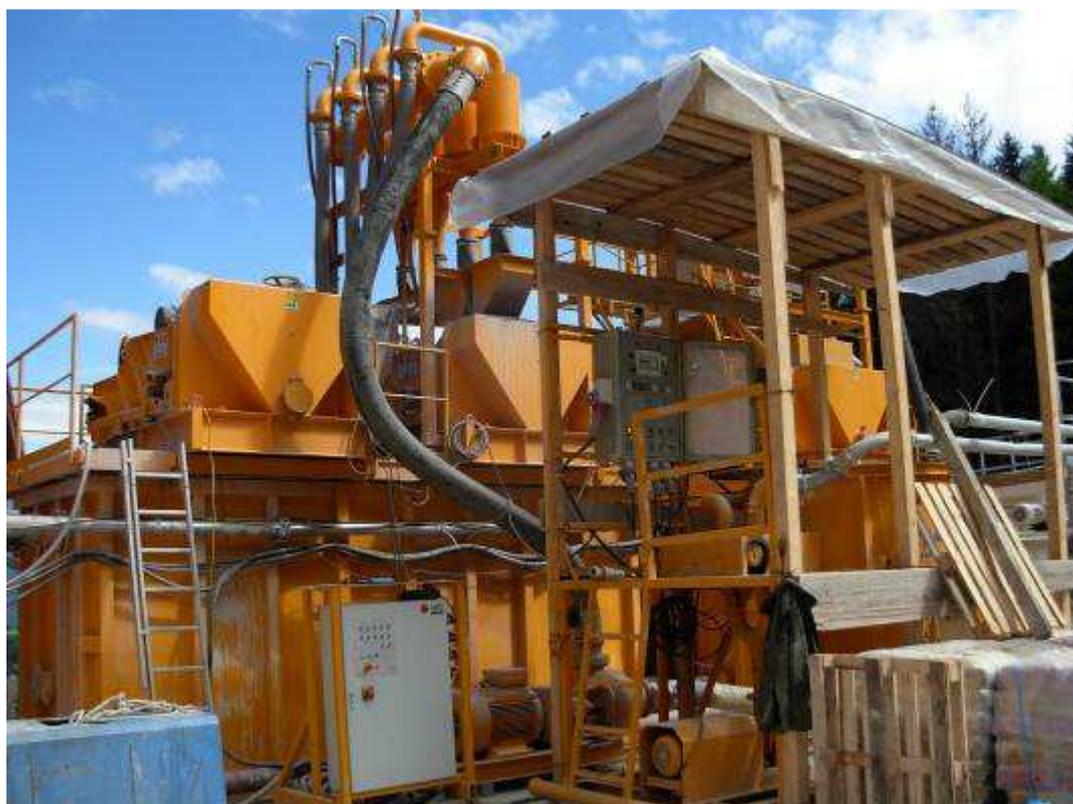
**Fig. 2.17 - Sistema di disidratazione**
