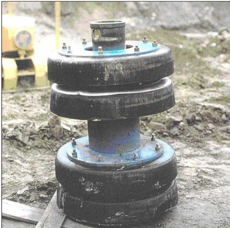
**Fig. 2.25 - Pig convenzionale impiegato nelle operazioni di collaudo idraulico e di pulizia della condotta.**
