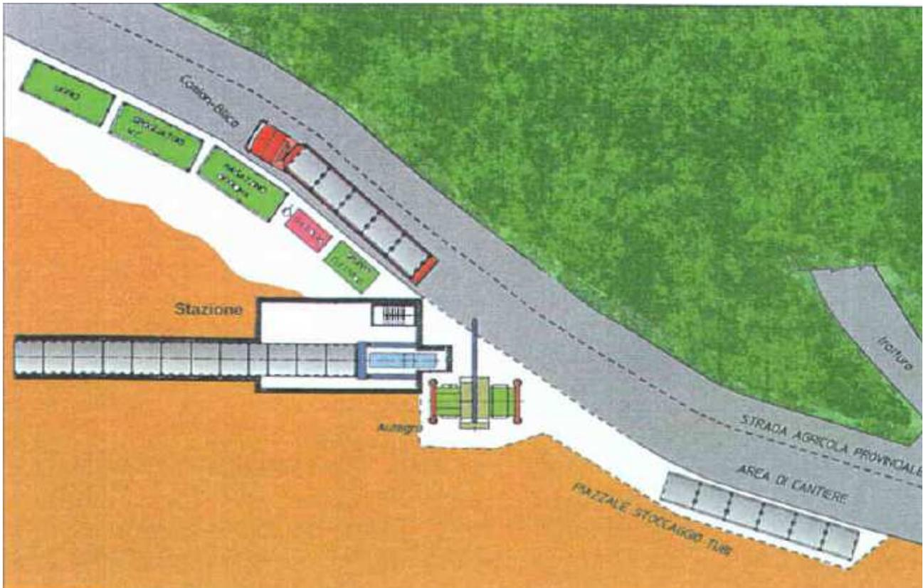
**Fig.5.2 - Schema tipo di una cantiere per l'installazione di un microtunnel.**
