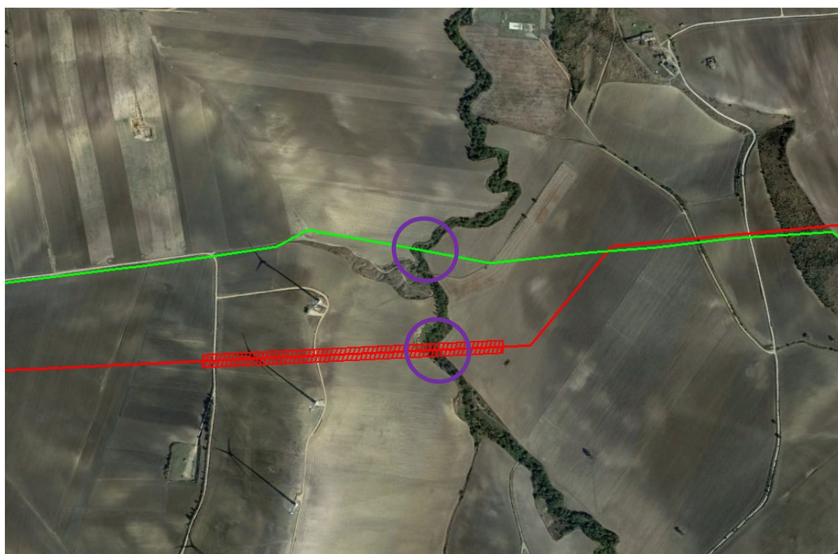
Fig. 4.11 - Tracciato di progetto ed Ortofoto del punto di attraversamento del torrente Salsola (cerchio viola) e localizzazione della stazione rappresentativa per la vegetazione ripariale
