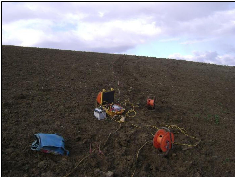
Foto postazione ERT7 dal E1 al E24
