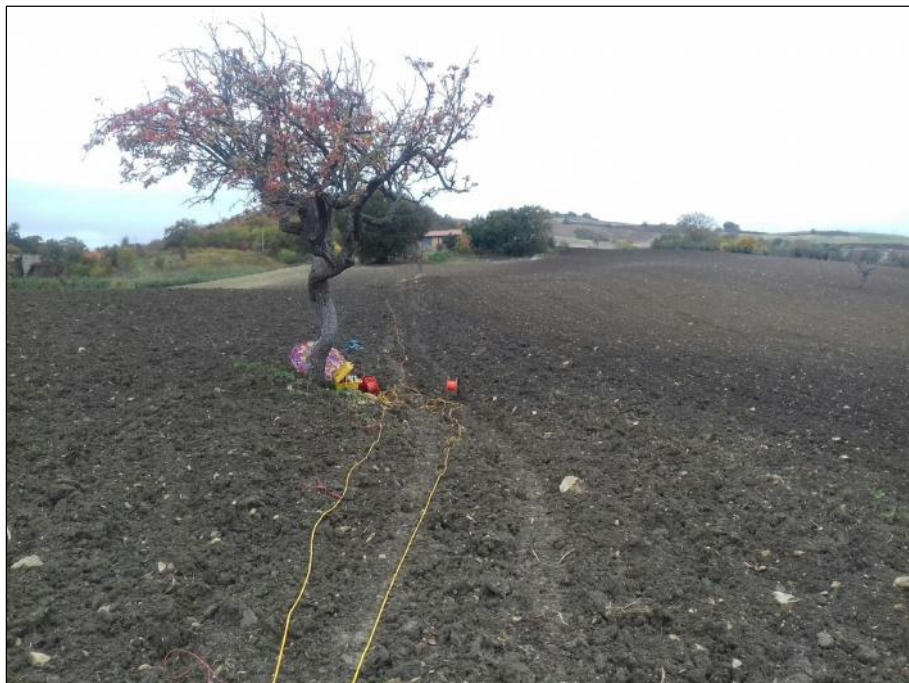
Foto postazione ERT2 dal E1 al E24
