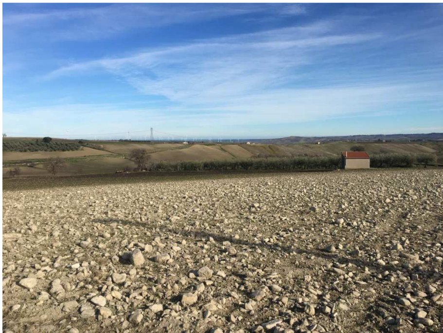
Figura 7.1-18 - Deposito ghiaioso-sabbioso-limoso alluvionale terrazzato a sud del Torrente Saccione - vicino progressiva km 45+200.
