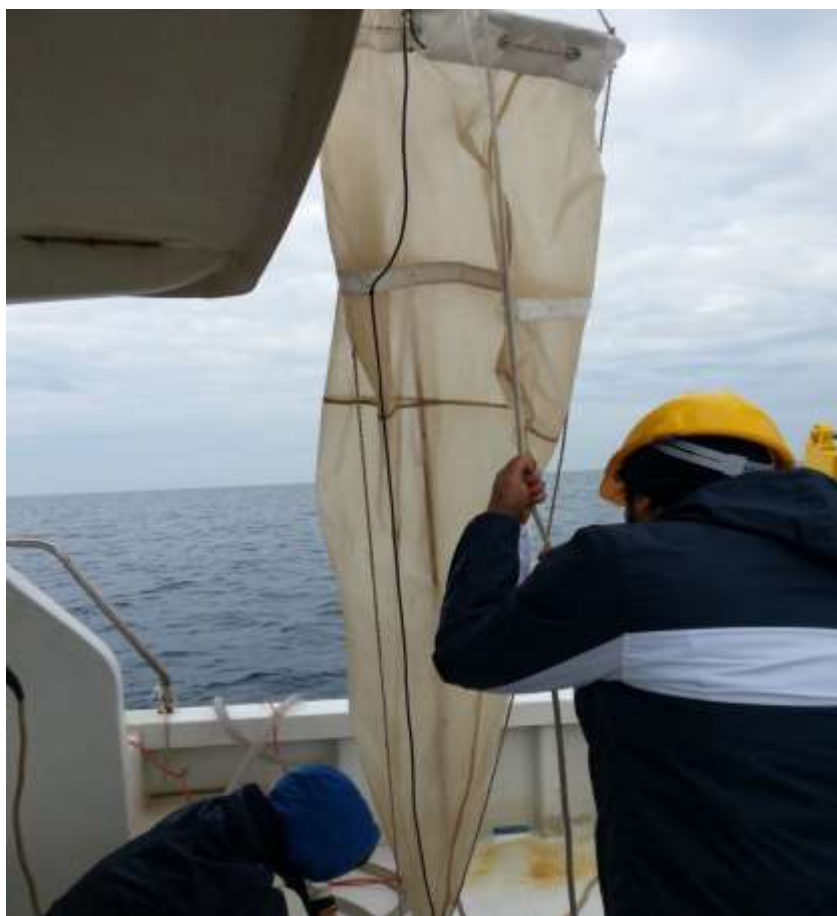
Figura 3.2: Retino utilizzato per il campionamento dello zooplancton
