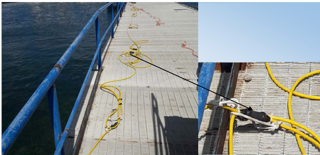
Figura 2 – Cavo in PUR con elettrodi in grafite – un momento della preparazione del cavo
