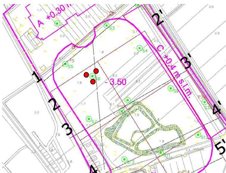
**Figura 15.** Nella figura sono indicate le posizioni (cerchi rossi), nell'intorno del punto S6, in cui sono stati effettuati i nuovi campionamenti per la verifica degli idrocarburi.
