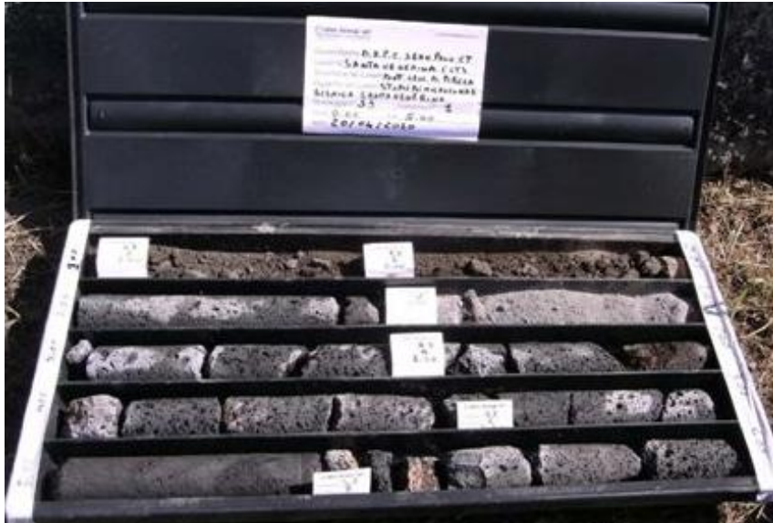
Figura 2 - Sondaggio verticale con carotiere
