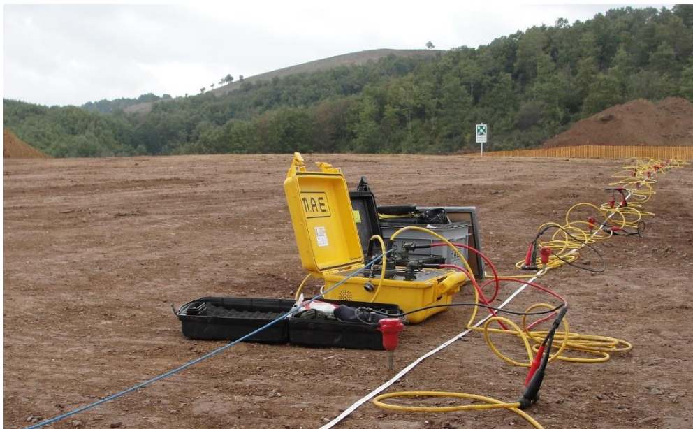
Figura 3 - Indagine sismica - Down Hole
