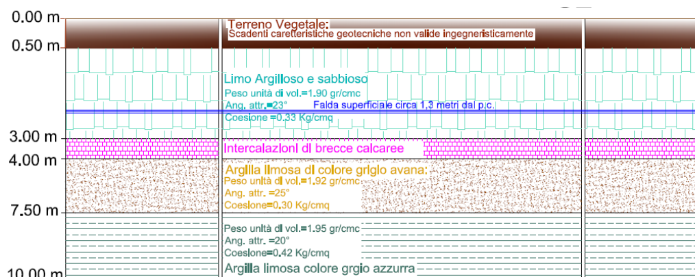
Figura 5 - Schematizzazione del modello geologico e geotecnico
