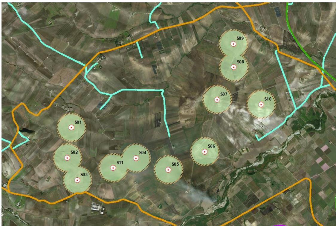
Tale distanza, ovvero 270 m, che è la minima, tra tutti gli aerogeneratori e una strada, risulta essere paragonabile (data la minima differenza di appena 30 m) alla distanza massima raggiunta degli elementi rotanti in caso di rottura accidentale, pari a circa a 300 m in via cautelativa, così come calcolata nell'elaborato "VWS-AMB-REL-043\_01 - Gittata massima degli elementi rotanti".
