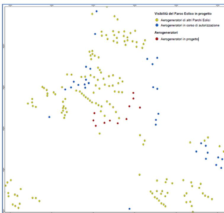
Figura 8 - Inquadramento del Parco eolico rispetto agli altri aerogeneratori realizzati e in fase autorizzativa
