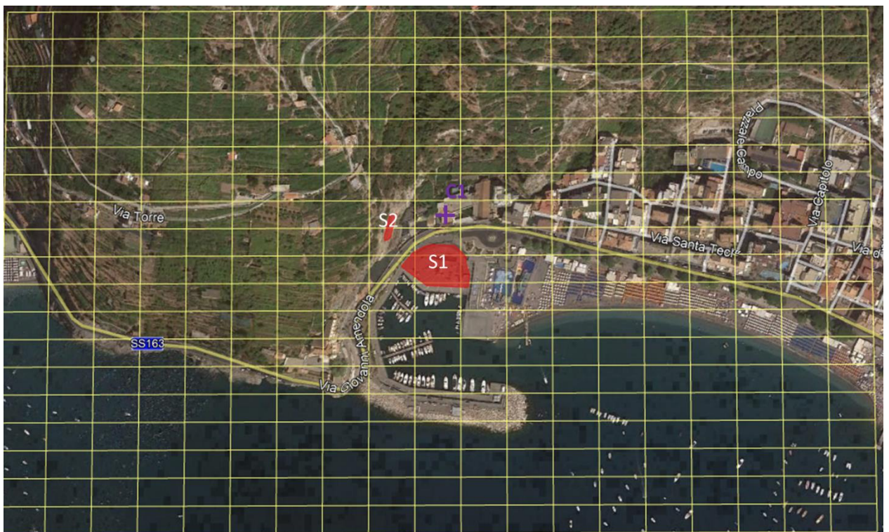
Figura 8-8 Schematizzazione sorgenti con maglia dei punti di calcolo (in giallo) in riferimento al territorio in esame e ricettore C1 (in viola)
