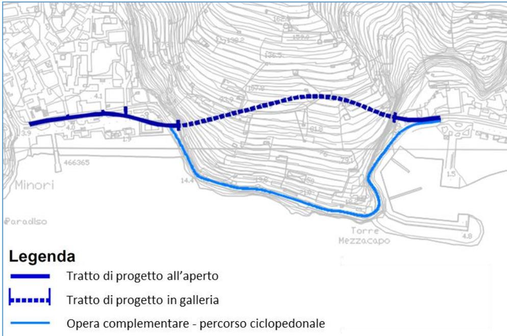
Figura 2-2 Schematico dell'alternativa 1
