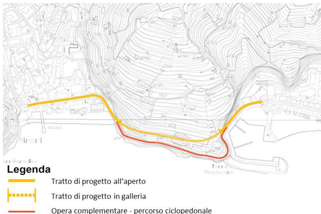
Figura 2-3 Schematico dell'alternativa 2
