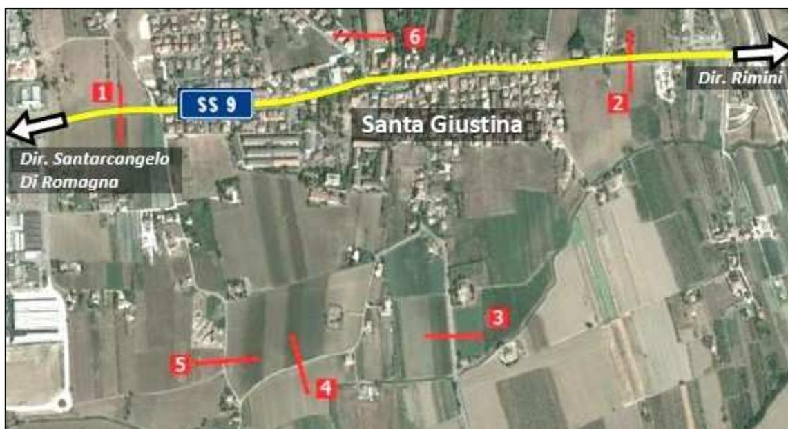
Figura 1: Sezioni di rilevamento dei traffici nell'area di progetto (Studio AIRIS S.r.l.)
